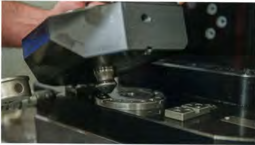
Bild 2: Im Zentrum der Komplettlösung von AMF stehen bewährte Nullpunktspannsysteme (Werkbilder 1+2: AMF, Fellbach)
